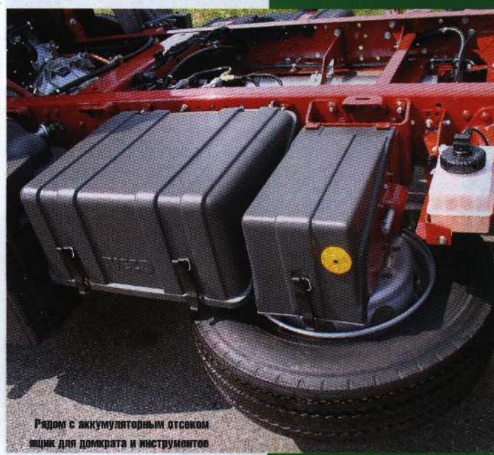
Рядом с аккумуляторным отсеком – ящик для домкрата и инструментов
