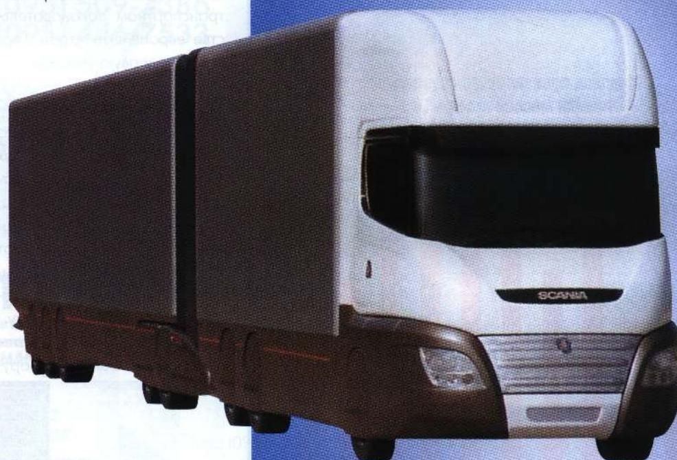
28-метровый концепт-трак с четырьмя поворотными осями и подкатной тележкой
