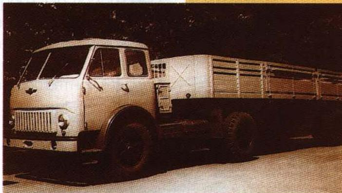
Седельные тягачи «МАЗ-504» с полуприцепами-платформами «МАЗ-5245» были распространены на перевозках строительных грузов. Фото автора
