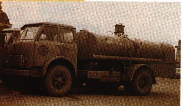
**Автотопливозаправщик «Т3-500» на шасси «МАЗ-500» имел цистерну объемом 8000 л и выпускался заводом «Стройформашин» с 1964 по 1970 год. Фото автора**
