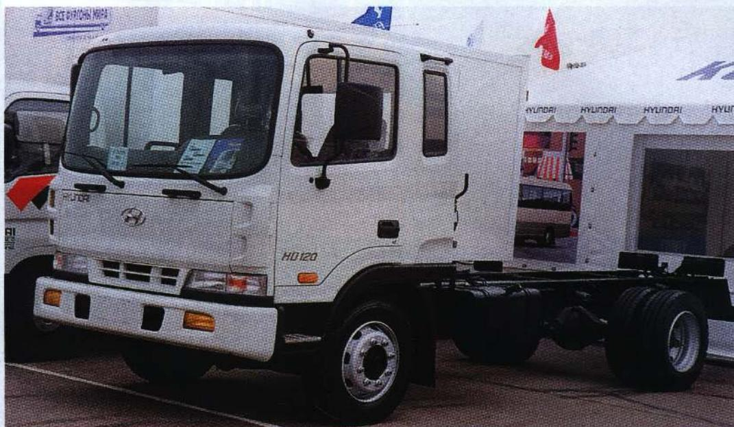
с несколькими вариантами размеров колесной базы от 3,8 до 6,2 м. Грузовики HYUNDAI, предназначенные
