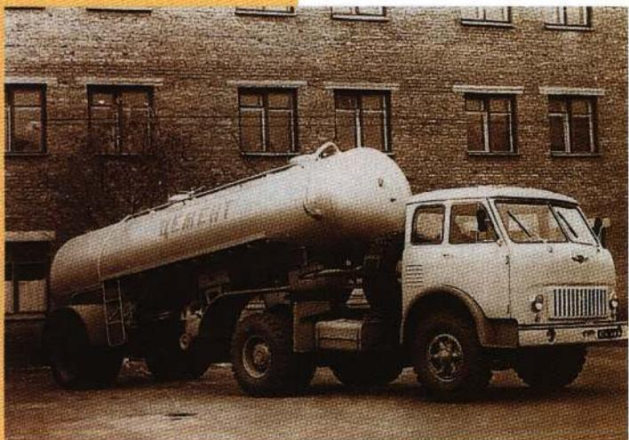
Полуприцепы-цементовозы «ТЦ-В» выпускались Красногорским заводом цементного машиностроения с 1967 по 1973 год. Они предназначались для работы с седельным тягачом «МАЗ-504А», оборудованным компрессором. Фото из архива А.С. Исаева
